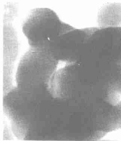
图2 \text{Eu}:\text{Y}_2\text{O}_3 纳米晶的透射电镜照片
